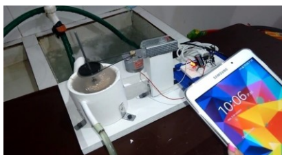
Figura 2. Primer prototipo terminado del sistema de almacenamiento hidroeléctrico
