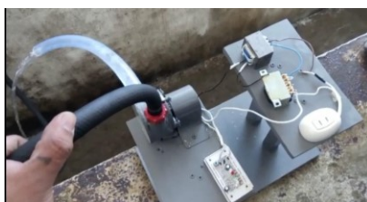
Figura 3. Segundo prototipo terminado del sistema de almacenamiento hidroeléctrico
