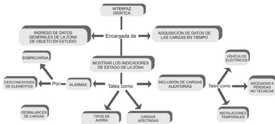
Figura 3. Modelo de interfaz gráfica para la red de distribución. Fuente: elaboración propia.
