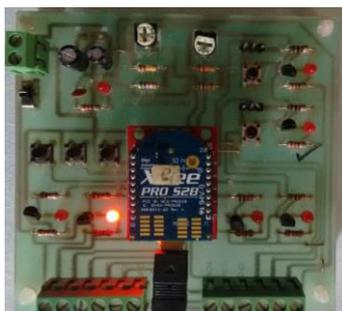
Figura 121. Modulo coordinador de la red Zigbee
