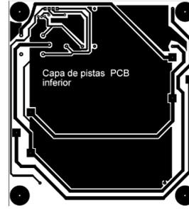
Figura 4. Diseño en board de la etapa de potencia
