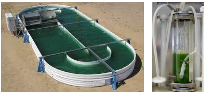
a) Estanques tipo raceway b) Fotobioreactor tipo columna de burbujeo [9]
