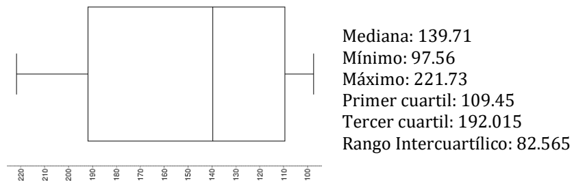
Figura 7. Distribución de valores de distancias máximas de cobertura para transmisores con potencia de 5980 Watts
