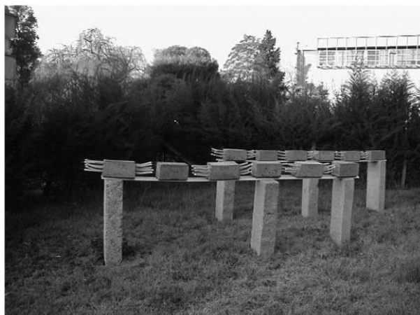
Figura 3. Probetas expuestas en ambiente industrial [18]
