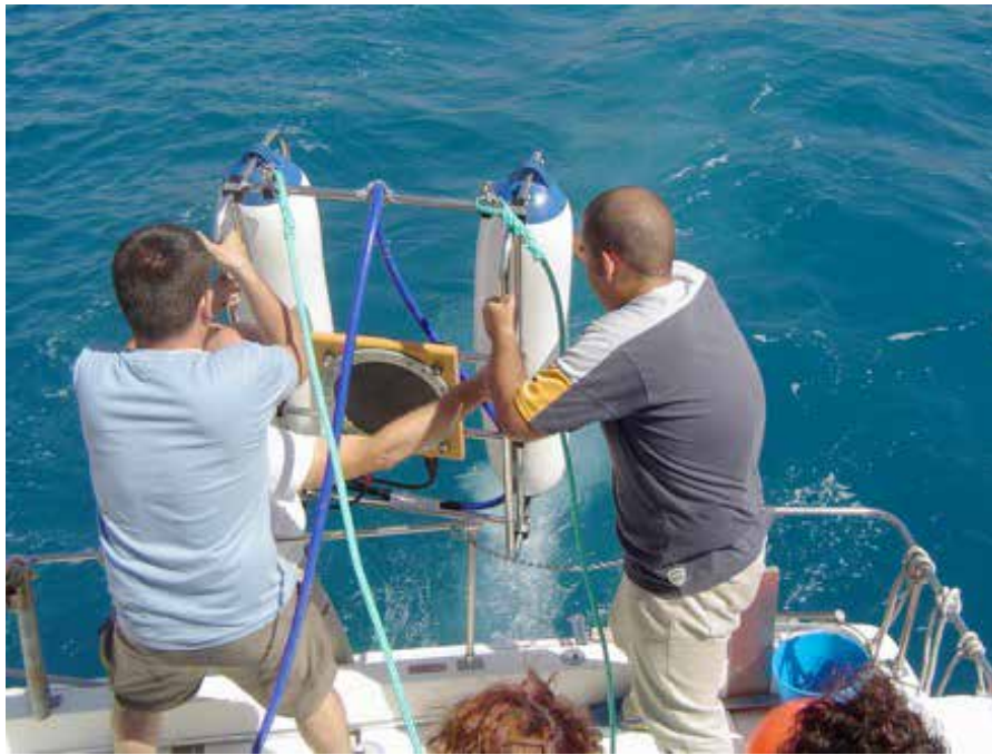
Figura 1. Fotografía del momento de colocar en el agua el catamarán del GeoPulse (Boomer) durante una de las prácticas con alumnos.
