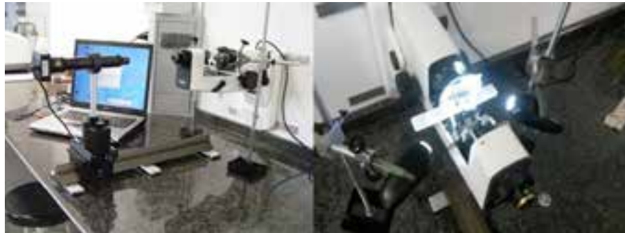
Figura 6. Montaje del alineado del instrumento y grabación de los videos de la visión a través del ocular
